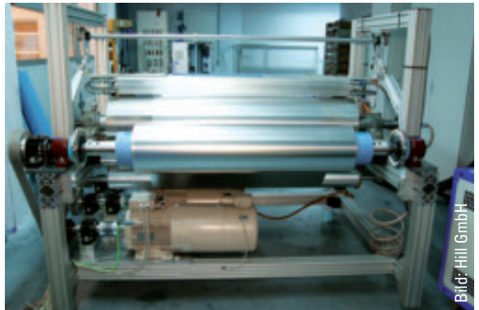
Abb. 1: Technikumsanlage zur Beflammung von Bahnenware bis 1,5 m Breite bei Geschwindigkeiten von 50–500 m/min
