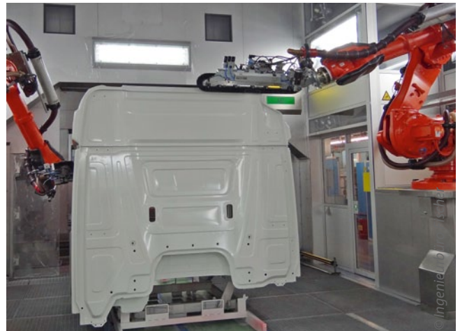
Bild 3: Reinigung der Außenhaut der Lkw-Fahrerkabine von Schleifstaub und Partikeln
