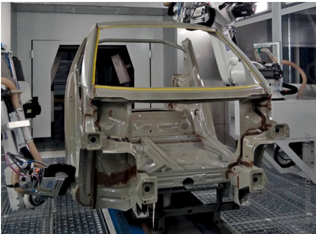
Bild 2: Zwei Roboterschwertbürsten bei der Reinigung der Smart-Karosse vor der Applikation des Basislackes
