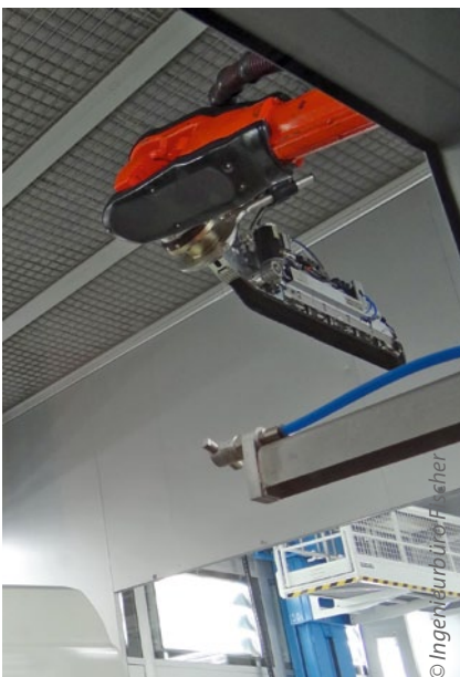
Bild 5: Tornado-Düse zur Selbstreinigung der Schwertbürste
