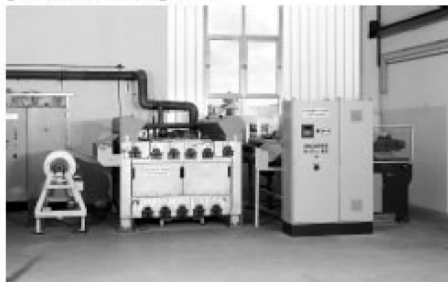
Abb 2: Infrarot-Anlage zur Fluorierung von Bahnware
