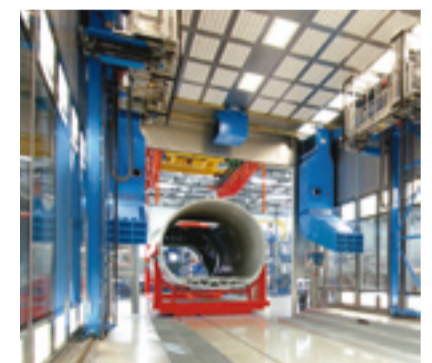
Großraumkabine zur Lackierung von Flugzeugrümpfen
