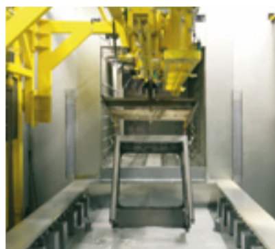
Vorbehandlungs- und KTL-Anlage für Traktorkabinen
