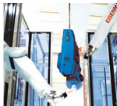
Pulverbeschichtung mit VarioRobot für Staplerteile
