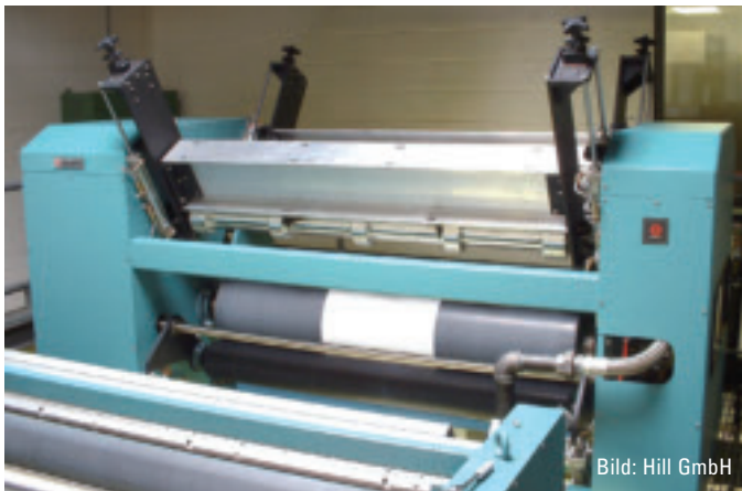
Abb.2: Beflammstation 1,5 m breit
