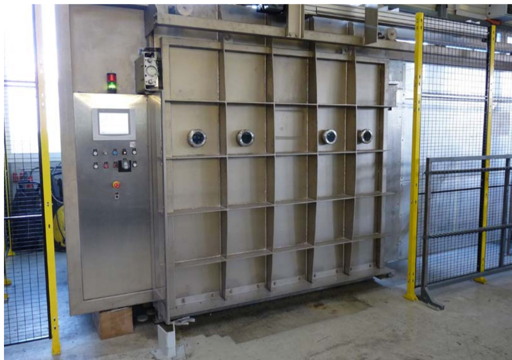
Die Firma Sommer hat jetzt eine neue, leistungsfähigere Plasmaanlage mit einem Nutzvolumen von acht Kubikmetern installiert. In der neuen Vakuumkammer können Bauteile mit den maximalen Abmessungen von zwei Metern Kantenlänge vorbehandelt werden. Quelle: Sommer Industrielackierung GmbH
